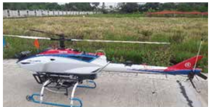
ภาพที่ 2 เฮลิคอปเตอร์แบบไร้คนขับของบริษัทไทยยามาฮามอเตอร์ รุ่น Yamaha FAZER
